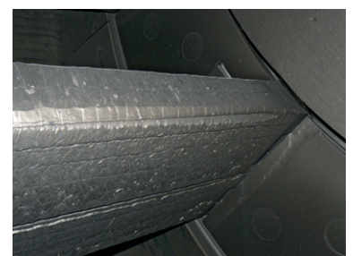
Mlecí deska – skutečnost po 1230 hod provozu
